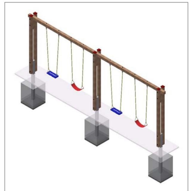
Après une à deux semaines de jeu, vérifier à nouveau tous les vis et raccords et les resserrer si nécessaire.
