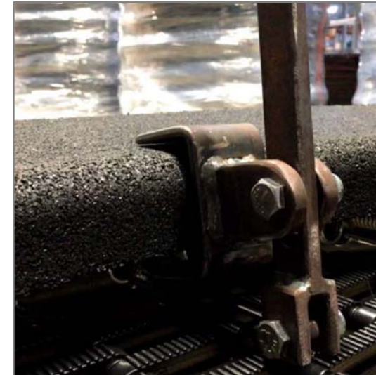
Bild-2 : Lösen der Federn, angesetztes Hakenwerkzeug
