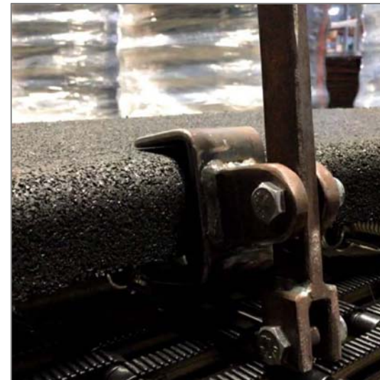
Bild-2 : Lösen der Federn, angesetztes Hakenwerkzeug
