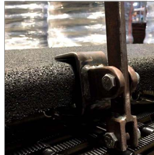
Photo-2 : Débander le ressort avec l'outil à crochet
