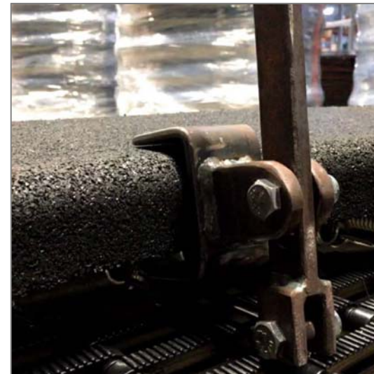
Bild-2 : Lösen der Federn, angesetztes Hakenwerkzeug
