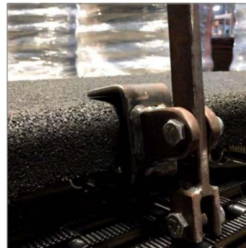
Bild-3 : Lösen der Federn, angesetztes Hakenwerkzeug
