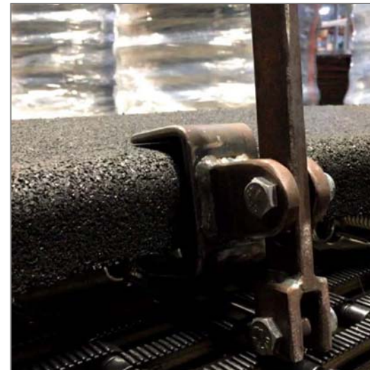
Photo-3 : Débâter le ressort avec l'outil à crochet
