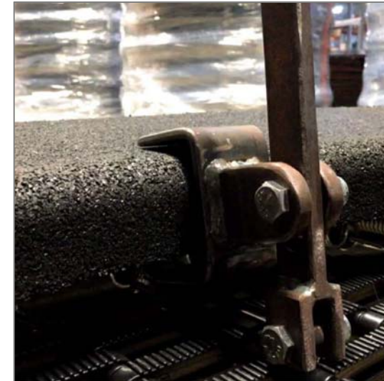
Bild-3 : Lösen der Federn, angesetztes Hakenwerkzeug
