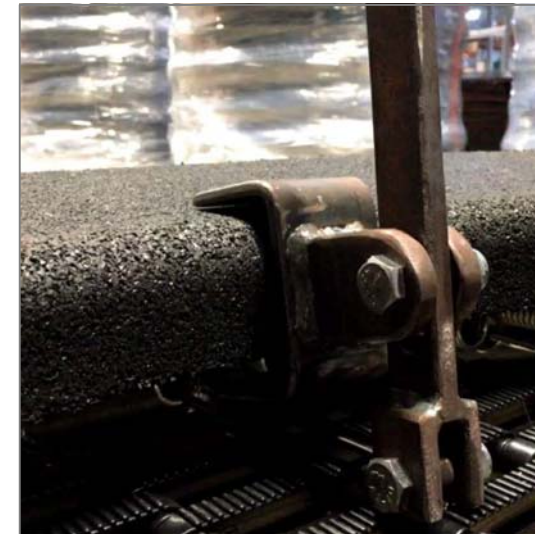
Bild-3 : Lösen der Federn, angesetztes Hakenwerkzeug
