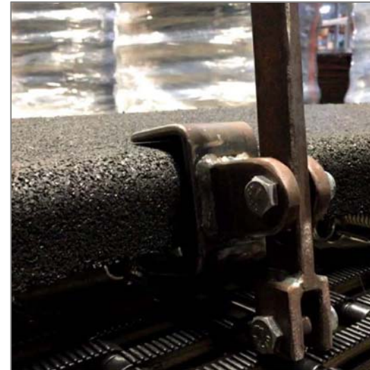
Bild-3 : Lösen der Federn, angesetztes Hakenwerkzeug
