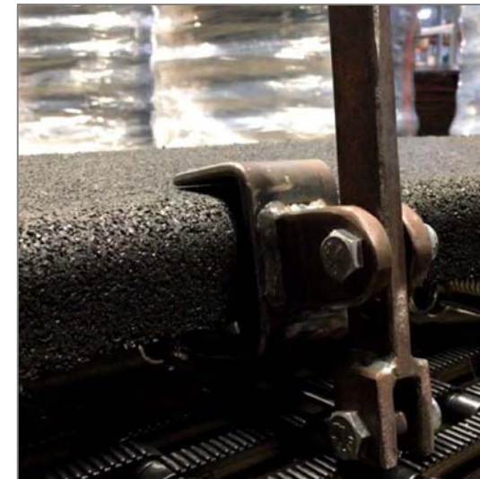
Bild-3 : Lösen der Federn, angesetztes Hakenwerkzeug
