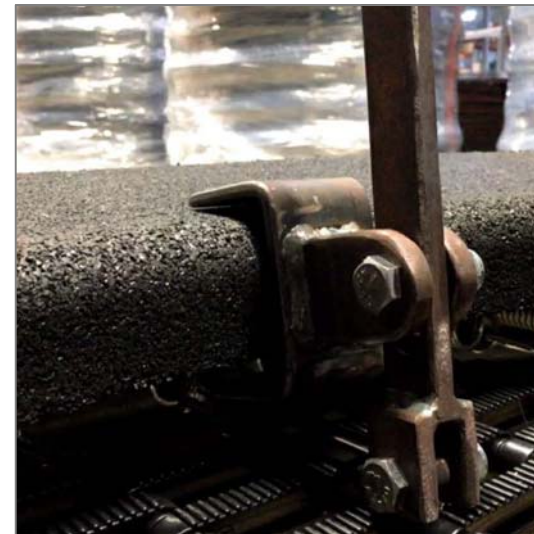
Photo-3 : Débânder le ressort avec l'outil à crochet
