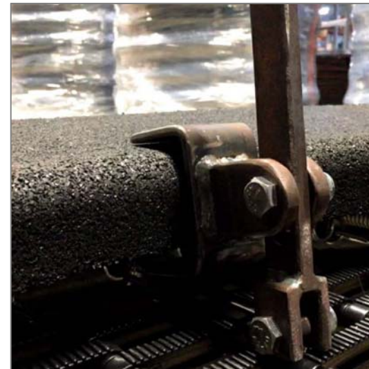
Bild-3 : Lösen der Federn, angesetztes Hakenwerkzeug
