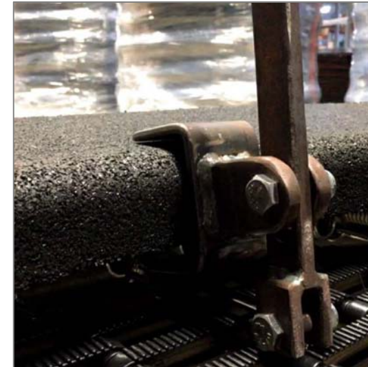
Bild-3 : Lösen der Federn, angesetztes Hakenwerkzeug
