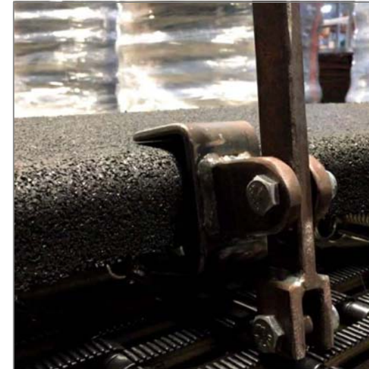
Bild-3 : Lösen der Federn, angesetztes Hakenwerkzeug
