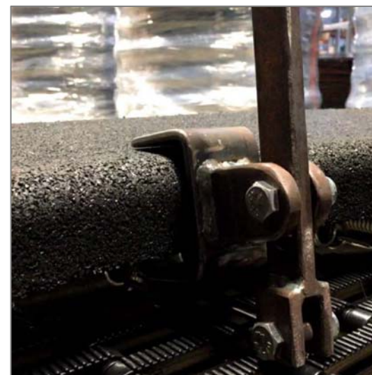
Photo-3 : Débander le ressort avec l'outil à crochet
