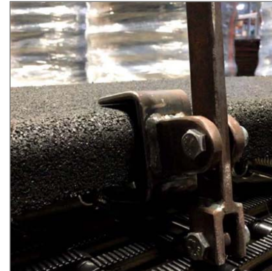
Bild-3 : Lösen der Federn, angesetztes Hakenwerkzeug
