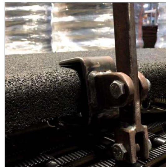
Bild-3 : Lösen der Federn, angesetztes Hakenwerkzeug
