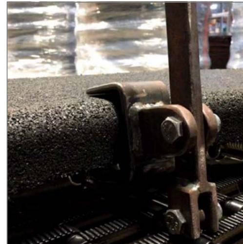
Bild-3 : Lösen der Federn, angesetztes Hakenwerkzeug
