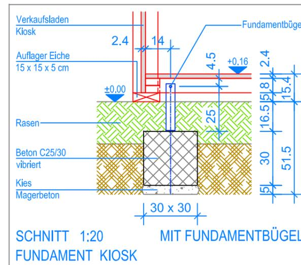
SCHNITT 1:20 MIT FUNDAMENTBÜGEL FUNDAMENT KIOSK
