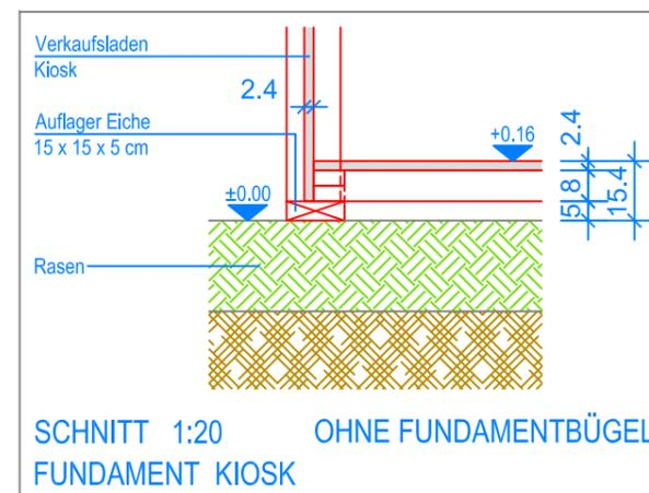
SCHNITT 1:20 OHNE FUNDAMENTBÜGEL FUNDAMENT KIOSK
