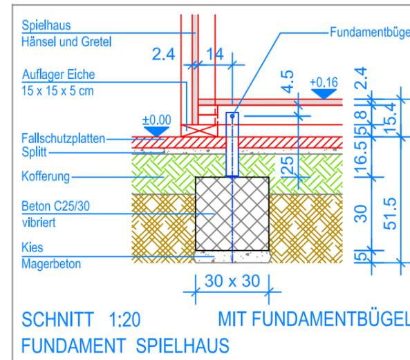
SCHNITT 1:20 MIT FUNDAMENTBÜGEL FUNDAMENT SPIELHAUS
