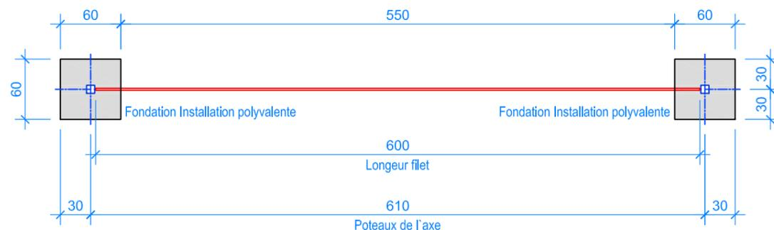
Les douilles des poteaux de l'installation polyvalente doivent être inclinées de 2° pour pouvoir obtenir une tension correcte du filet pour badminton.
