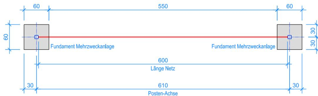
Die Bodenhöhlen der Mehrzweckanlage müssen 2° aus dem Lot gesetzt werden, um eine Vorspannung des Badmintonnetzes zu erreichen.
