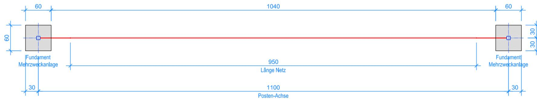
Die Bodenhülsen der Mehrzweckanlage müssen 2° aus dem Lot gesetzt werden, um eine Vorspannung des Volleyballnetzes zu erreichen.
