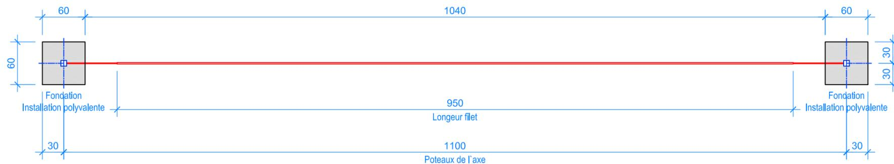
Les douilles des poteaux de l'installation polyvalente doivent être inclinées de 2° pour pouvoir obtenir une tension correcte du filet pour volley-ball.
