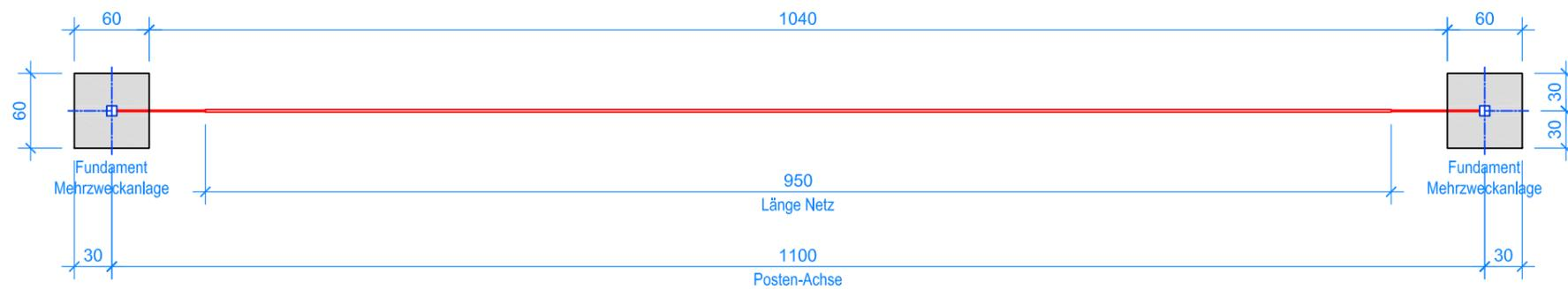
Die Bodenhöhlen der Mehrzweckanlage müssen 2° aus dem Lot gesetzt werden, um eine Vorspannung des Volleyballnetzes zu erreichen.
