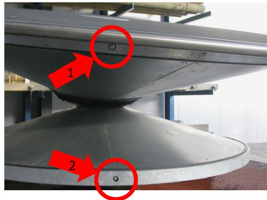
1. Graisseur pour la rotule situé sous l'anneau en acier inox du plateau
